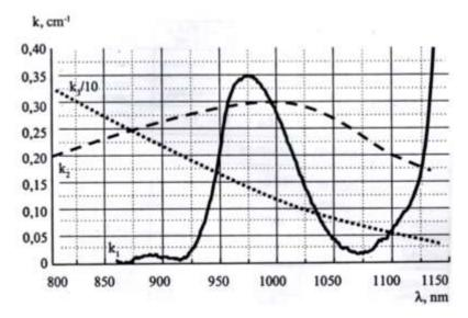
**Рис.2** Относительное поглощение лазерного излучения в воде  $(k_1)$ , оксигемоглобине  $(k_2)$  и меланине  $(k_3)$  в районе  $\lambda = 1$  мкм [3].
