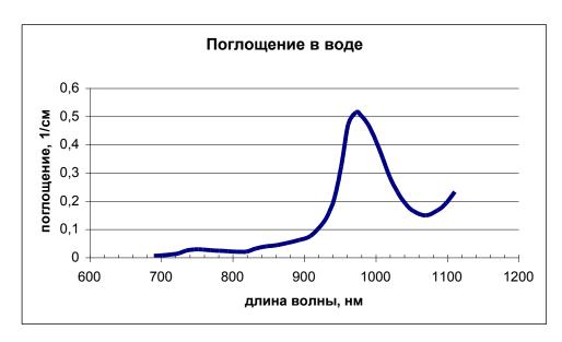
**Рис. 1.** График поглощения в воде лазерного излучения ближнего инфракрасного лиапазона.
